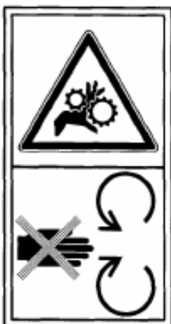
Рисунок 7.7 – Соблюдайте осторожность в опасной зоне. Избегайте соприкосновения любой части тела или одежды с движущимися элементами приспособления.
