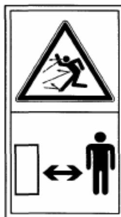
Рисунок 7.4 – Опасность выброса твердых предметов руслами приспособления. Находитесь на безопасном расстоянии от работающего приспособления.
