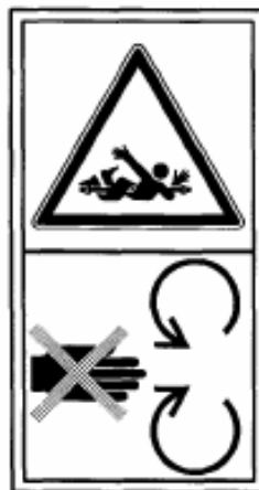
Рисунок 7.6 – Не допускайте соприкосновения любой части тела или одежды с карданным валом во время работы приспособления.
