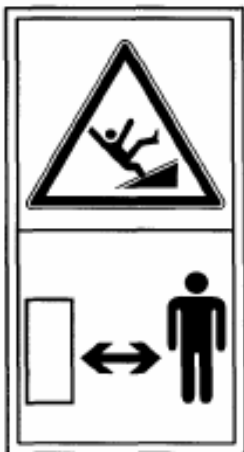
Рисунок 7.5 – Опасность захвата подающими цепями и вальцами приспособления. Находитесь в отдалении от работающего приспособления. Выключите двигатель и извлеките стартовый ключ, прежде чем приступить к техническому обслуживанию, ремонту приспособления или перед устранением забивания приспособления.
