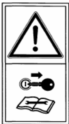
Рисунок 7.3 – Перед техобслуживанием и ремонтом выключите двигатель комбайна и извлеките стартовый ключ.
